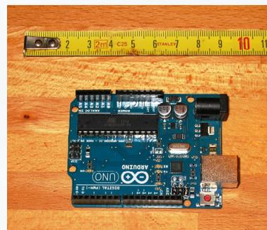
Scheda microcontrollore ARDUINO UNO, costruita in Italia e diffusa in tutto il mondo. Questa scheda permette, in modo semplice ed accessibile a tutti, di gestire segnali in ingresso ed in uscita mediante un programma caricato nella sua memoria tramite un qualsiasi PC, utilizzando la porta USB.
